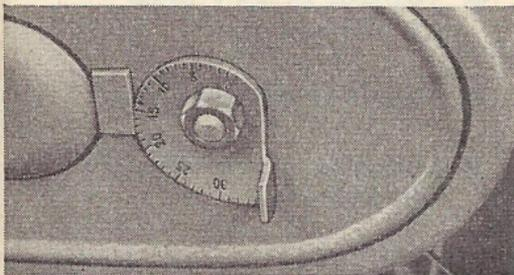
Die Exzenter-Kettenspanner ermöglichen ein einfaches und leichtes Nachspannen
